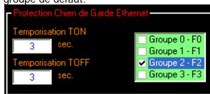
*Zone de paramétrage de la protection en communication réglée à 3 secondes en perte (TOFF) et 3 secondes en reprise (TON) sur le Groupe F2.*
