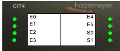
Visualisation des E/S du module d'extension Ext 1, jusqu'à 16 Entrées et 8 Sorties (Idem pour Ext 2) :
