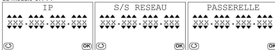
A partir de ces 3 écrans et en utilisant les touches de navigation ◀ ▶ ▲ ▼, on renseignera les trois adresses : IP, Sous-réseau et passerelle.
